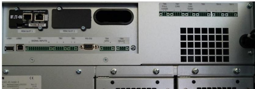
Die 2 Mini-Slot-Karten für optional erhältliche Relais-, ModBus-, CanBus-, SNMP(enthalten) Karten, und sämtliche Steuer- und Relaiskontakte befinden sich oberhalb der Sicherungselemente, links auf der Frontseite der USV. Durch einen kleinen Kabelschacht auf derselben Höhe können die Steuer/ Datenleitungen auf die Rückseite der USV verbracht werden.
